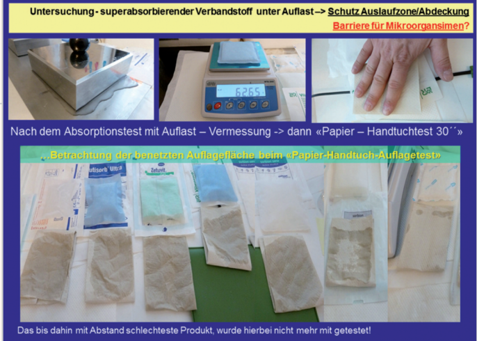
Abb. 2: Testanordnung: Verschiedenen Produkte nach kompletter Sättigung. Die auf die Rückseite aufgelegten Papierhandtücher erscheinen nach 30 Sekunden Auflagezeit bei fast allen Produkten als nass.
